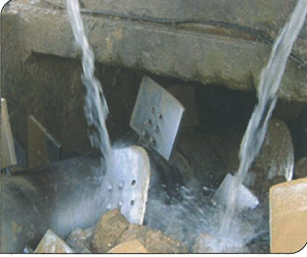
Kum yıkama tamburu karıştırıcı kolları HARDOX 550
