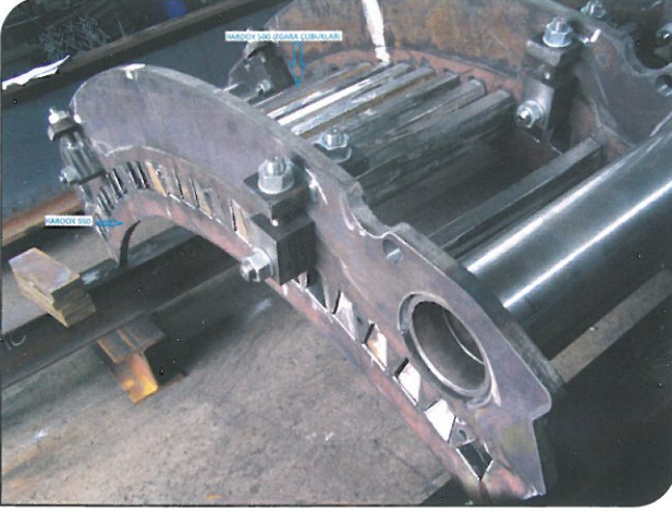
HARDOX aşınma plakalarından imal edilmiş komple çekiçli kırıcı ızgara beşikleri Izgara çubukları - HARDOX 500 Izgara tutucu plakaları - HARDOX 450
