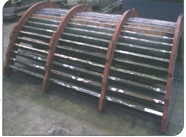
HARDOX aşınma plakalarından imal edilmiş komple çekiçli kırıcı ızgara beşikleri Izgara çubukları - HARDOX 500 Izgara tutucu plakaları - HARDOX 450
